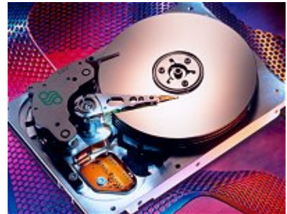
Typischer Aufbau: Eine Festplatte besitzt in der Regel drei Platten und sechs Schreib-/Leseköpfe.
